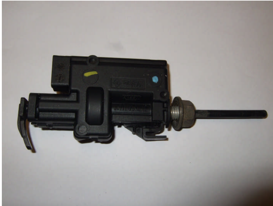
Demontierte Tankklappenverriegelung
