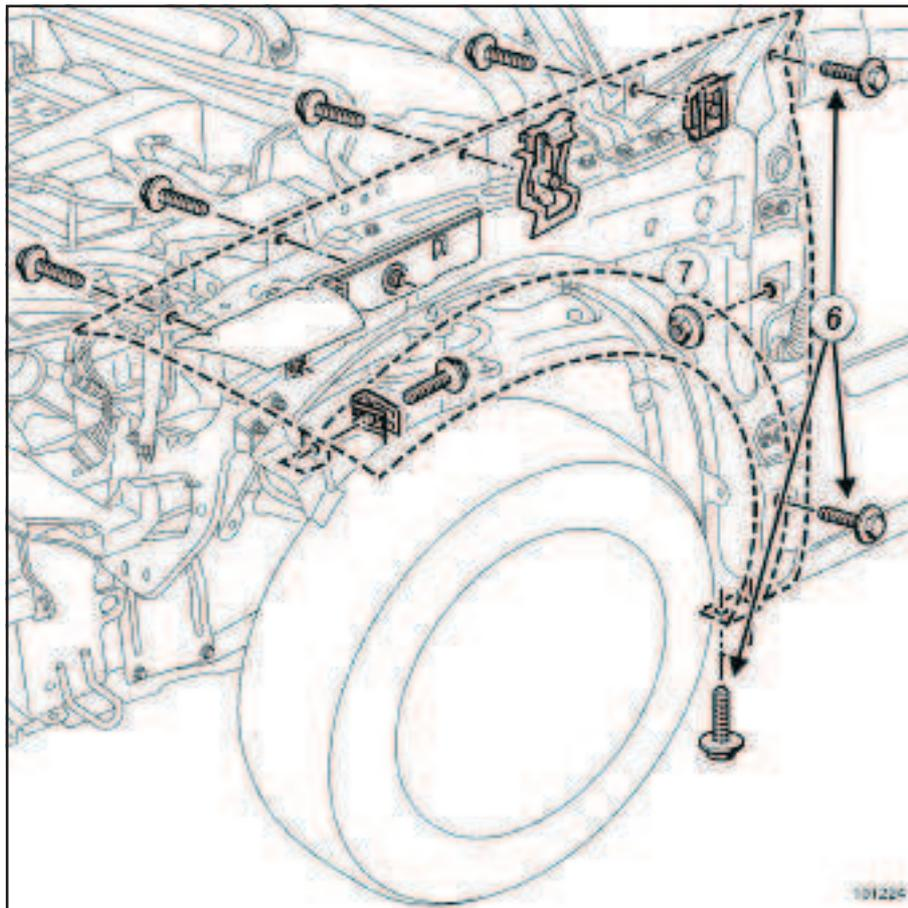
Die Passgenauigkeit gewährleisten und die Ausrichtung mit der Vordertür über die Befestigungen (6) und (7) einstellen.
