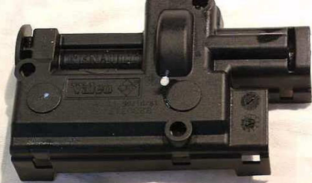
Die Achse mit Sperrstift ist nur ins Gehäuse eingelegt
